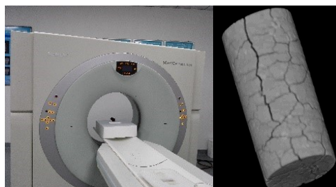
图 2 Sensation 40 CT 机及 CT 重建图像
